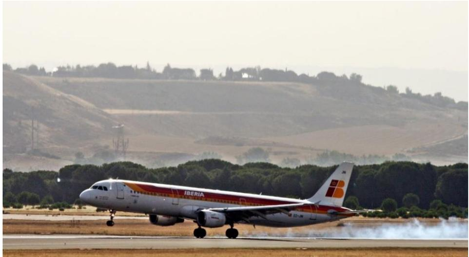
En el momento de tomar tierra hasta que ruedan sin deslizar por la pista, los neumáticos del avión dejan sobre el pavimento una cantidad determinada de caucho. Con el paso sucesivo de las aeronaves, se formará una gran mancha en la zona de toma de contacto, que debe ser vigilada.
