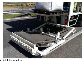
El equipo de granallado de Röhsler & Co necesita mínima implicación del cliente, siendo únicamente necesario contar con un camión grúa a la mitad y al final de cada jornada, para realizar la descarga de los big-bags generados durante los trabajos.
